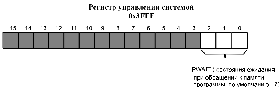
Рис. 10.3 Группа разрядов состояний ожидания памяти программ в регистре управления системой
